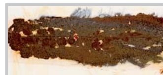
Salzprühtest: Keine Rostschutzwirkung
